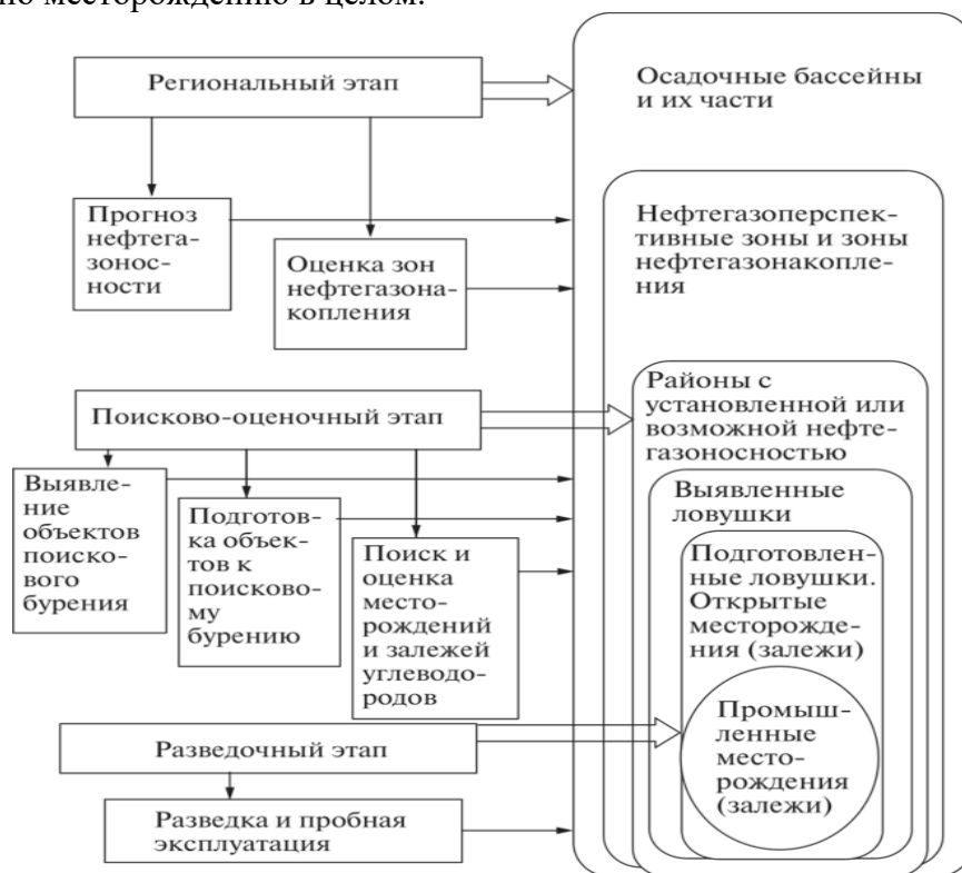
1-рисунок. Основные методы поисково-разведочных работ на нефть и газ (Нефть и газ/Разведка)
