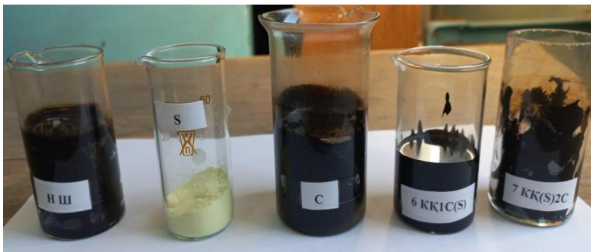
2-расм. HSH-нефт шлами, S-олтингугурт, C-соапсток, иккиламчи 6KК1C(S) қурилиш ва 7KК(S)2C йўл битуми намуналари фото суратлари
