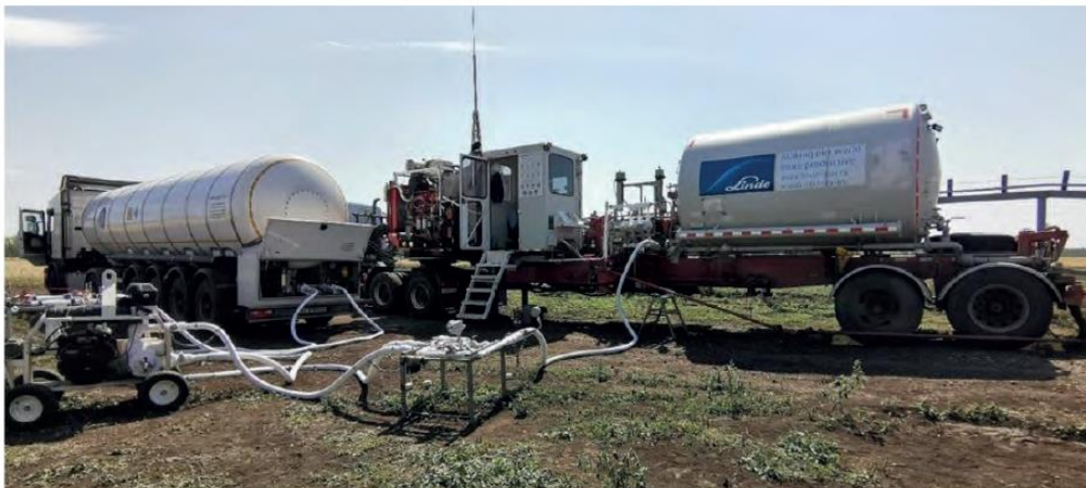
1-rasm. Suyuq CO 2 uchun avtomobil izotermik rezervuar (chapda) va CO 2 ni siklik haydash uchun MGNA (o'ngda)
